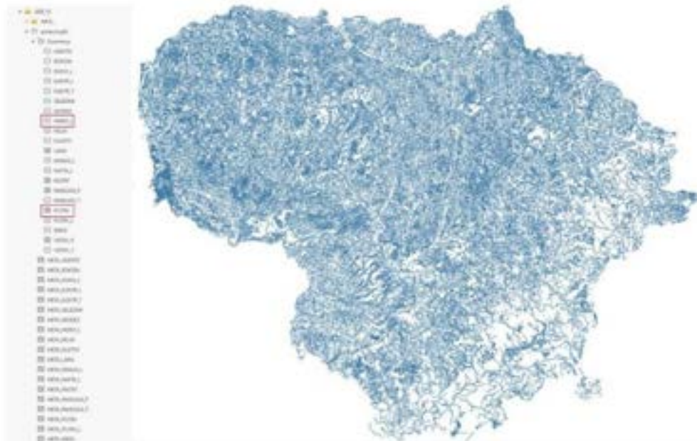
2 pav. GRPK Georeferencinio pagrindo kadastro erdvinių duomenų rinkinio (GDB_10) HIDRO_L vektorinio linijinio duomenų sluoksnio duomenys
